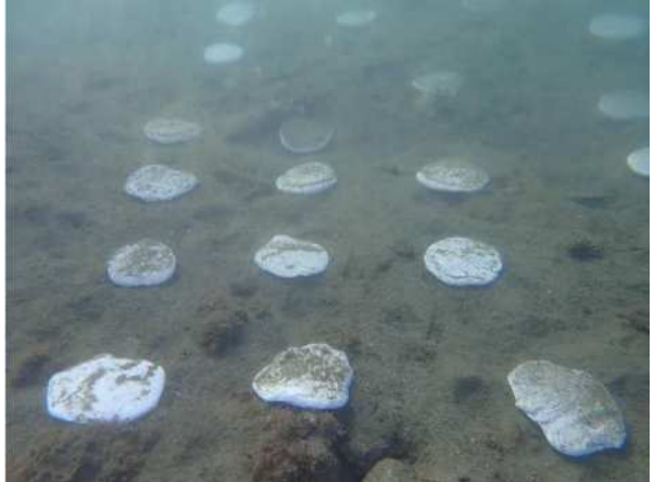
図8 紙粘土設置（坊泊漁港：覆砂前）
